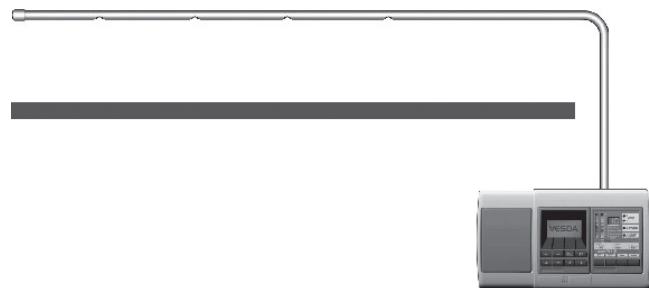
그림 18. 케이블 트레이 상단과 천정사이에서의 샘플링
